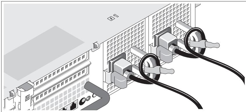
Ohněte napájecí kabel do smyčky, jak je znázorněno na obrázku, a připevněte jej dodanou páskou k držáku.
