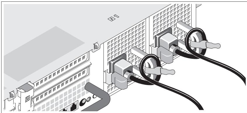
Zegnij kabel (kable) zasilania komputera w pętlę, w sposób przedstawiony na rysunku i zamocuj kabel na wsporniku, używając załączonej opaski.
