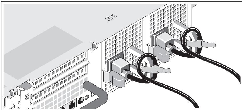
Sistemin güç kablosunu resimde gösterildiği gibi ilmek yapın ve kabloyu sistemle birlikte verilen şeridi kullanarak desteği sabitleyin.
