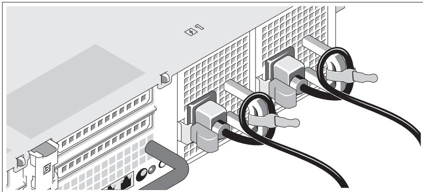
Τυλίξτε τα καλώδια τροφοδοσίας του συστήματος όπως φαίνεται στην εικόνα και στερεώστε τα στο στήριγμα χρησιμοποιώντας την παρεχόμενη ταινία.
