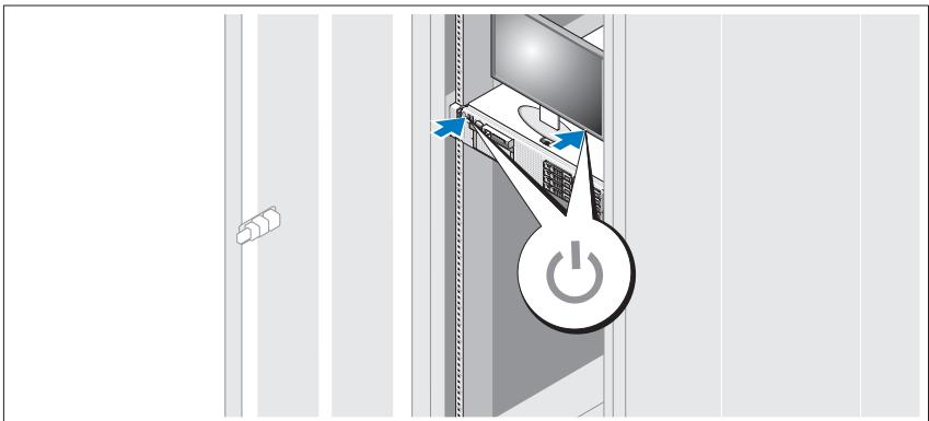
Drücken Sie den Netzschalter am System und am optionalen Bildschirm, falls verwendet. Daraufhin sollten die Betriebsanzeigen aufleuchten.
