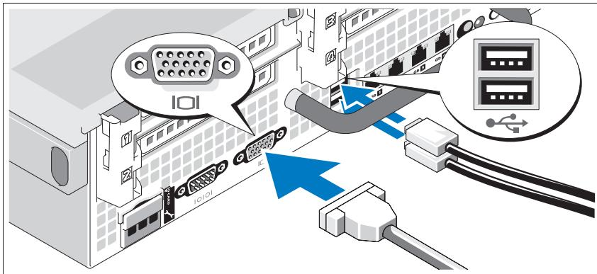
Подключите клавиатуру, мышь и монитор (дополнительно).
