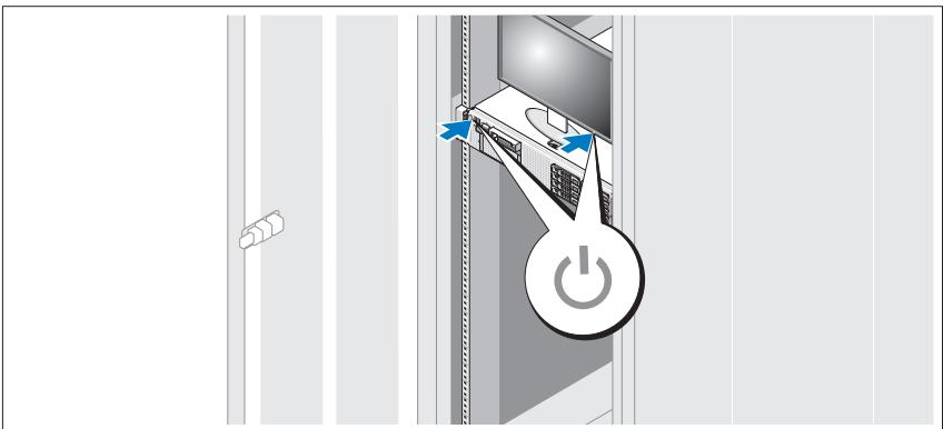
Нажмите кнопку питания на системном блоке и на дополнительном мониторе (если используется). Должны загореться индикаторы питания.
