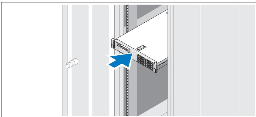
Смонтируйте направляющие кронштейны и установите систему в стойку согласно инструкциям по технике безопасности и инструкциям по монтажу в стойку. Эти инструкции прилагаются к системе.
