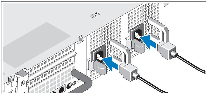
Podłącz odpowiedni kabel (lub kable) zasilania do komputera oraz odpowiedni kabel (lub kable) zasilania do monitora, o ile jest używany.
