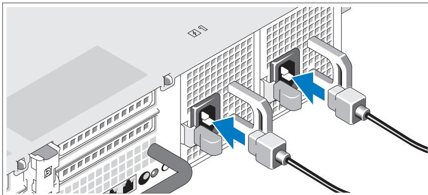
Συνδέστε το(τα) καλώδιο(α) τροφοδοσίας του συστήματος στο σύστημα και, εάν χρησιμοποιείτε οθόνη, συνδέστε το καλώδιο τροφοδοσίας της οθόνης στην οθόνη.
